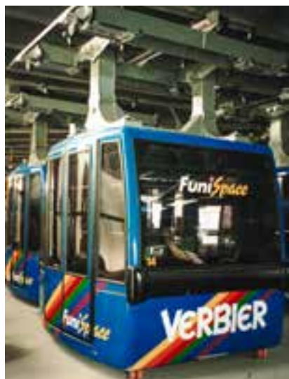
Ci-dessus, les cabines de 30 places, dans leur habit d'origine. Elles sont entraînées par un double câble parallèle, avec une résistance au vent jusqu'à 100 km/h. L'installation a coûté 27 millions de francs.
