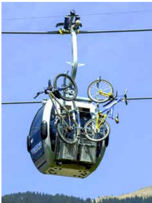
Construit par l'entreprise STA au début des années 2000, le premier porte-vélos se résume à une perche rehaussée d'un crochet.
